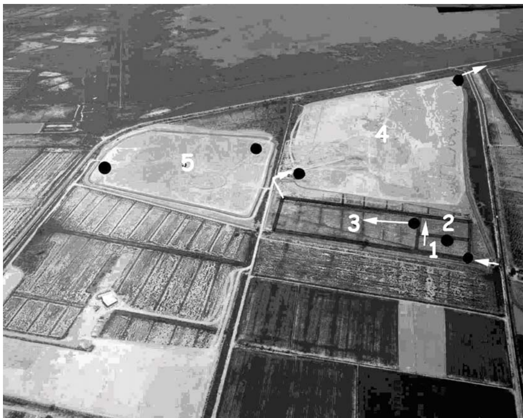
FIG. 2.- Esquema de la situación de los sistemas lagunares sobre fotografía aérea. Se observa el sistema de depuración de las balsas (1, 2 y 3), la laguna El Rincón (4) y la laguna El Saladar (5). Los puntos indican las zonas de entrada y salida del agua y las flechas el sentido de su circulación. Figura orientada al este. Fuente: Sánchez et al. (2001).
